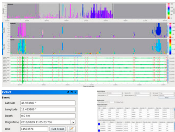
重新设计的波形数据交互审查软件：主要窗口和事件分析工具（针对事件和扫描功能）
