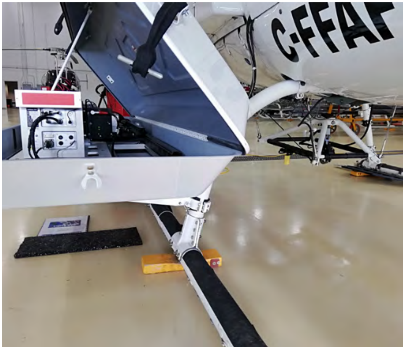
Система МИС на вертолете AS350 во время проходившего в Канаде курса подготовки по авиационным методам продвинутого уровня в рамках третьего учебного цикла по ИНМ
