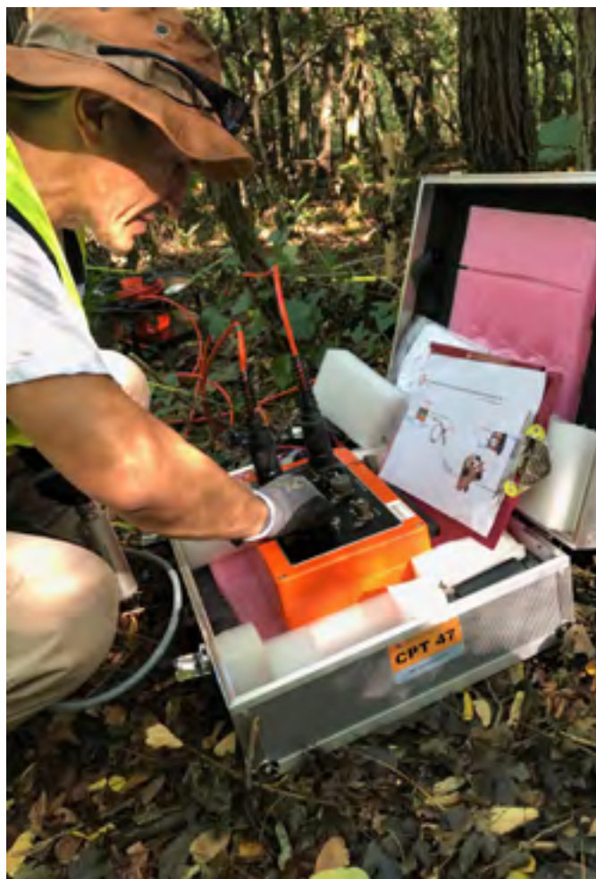
Измерения электропроводности в ходе состоявшихся в 2019 году полевых испытаний геофизических методов ИНМ в Венгрии
