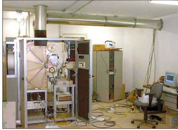
مُعابن دقائقي أوتوماتي للهواء، مركَّب في محطة رصد النويدات المشعة RN11 في ريو دي جانيرو، البرازيل.
