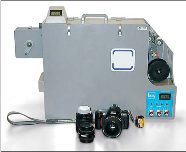
جهاز محمول لمعالجة أشرطة الصور الفوتوغرافية الملونة.
