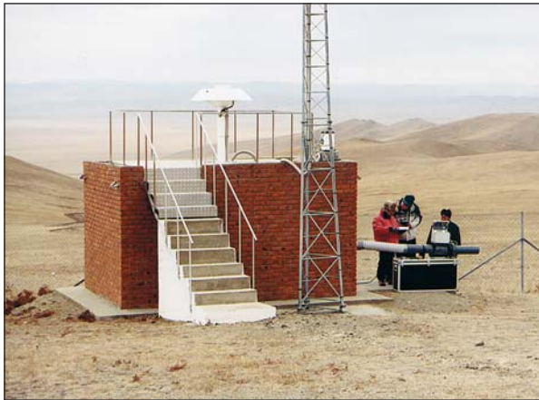
قياس تدفق الهواء عبر الجهاز اليدوي لمعاينة الهواء لقياس الجسيمات في محطة رصد النويدات المشعة RN45 في أولان باتور، منغوليا.
