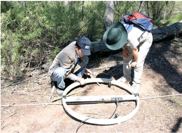
Demostración de equipo para IIS, Australia: nivelación de una bobina receptora utilizada para medir campos magnéticos inducidos.
