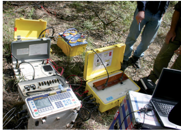
Demostración de equipo para IIS, Australia: equipo de medición de la resistividad.
