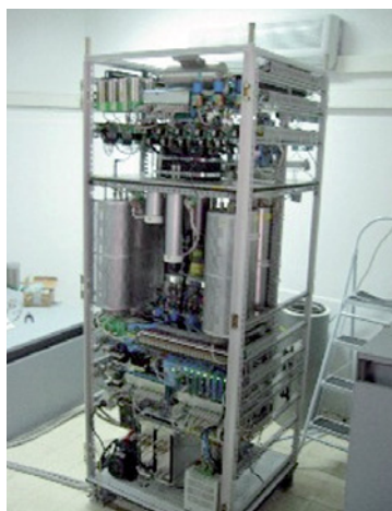
Dos nuevos sistemas de gases nobles instalados en 2005 en Estocolmo (SAUNA-II) y Buenos Aires (ARIX-02).
