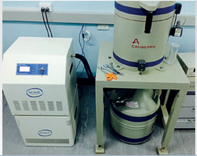
新的液态氮发生器，安装在斐济楠迪放射性核素台站 RN26。
