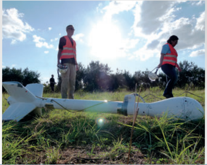
2013年9月在意大利举行的机载技术技能培训期间代理视察员操作机载磁强计。
