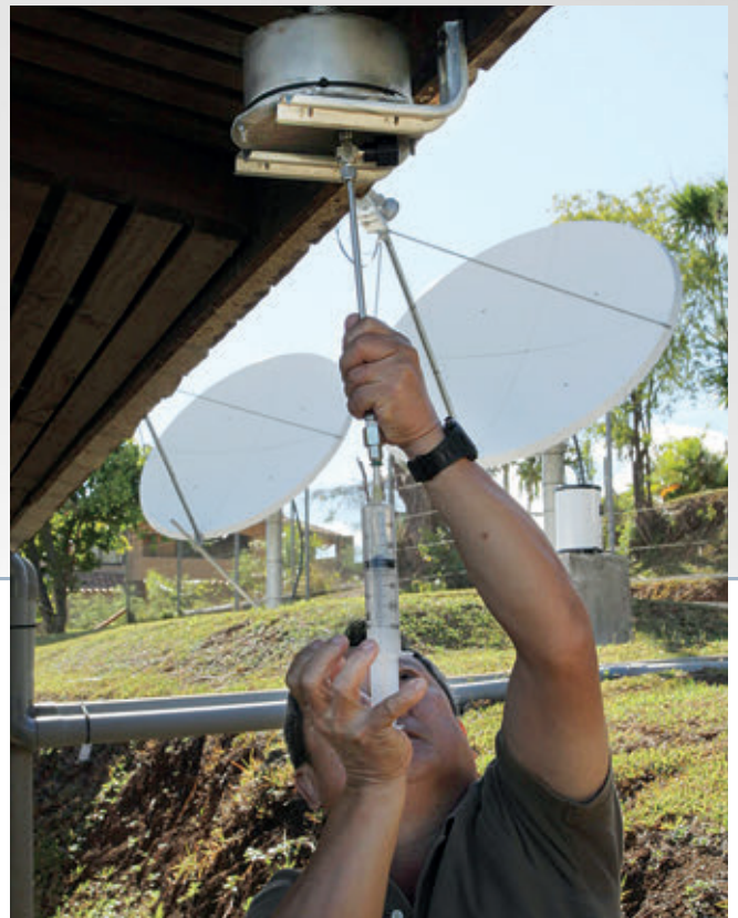
在法国塔希提帕皮提放射性核素台站 RN27 进行峰值测试,作为惰性气体系统核证的一部分。
