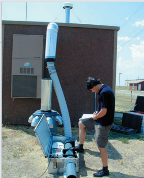
Контроль производимого измерения воздушного потока на радионуклидной станции RN74, Ашленд, Канзас, США.
