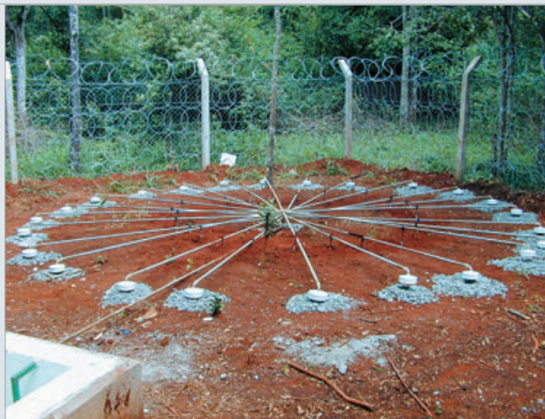
Система подавления ветровых шумов на инфразвуковой станции IS32, Найроби, Кения.
