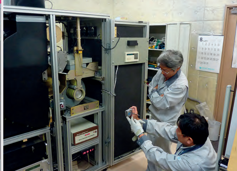
操作人员正在核证 RN38 探测器的安装。
