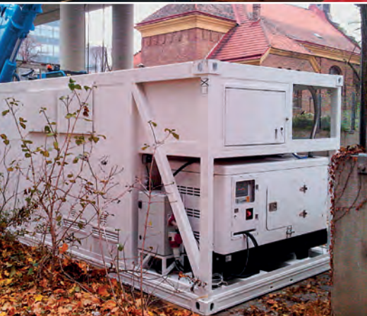
为了便利测量全球放射性氙本底，可以在各个站址临时部署便携式设备。上：(美国)太平洋西北国家实验室研制的、使用(瑞典)SAUNA系统的便携式氙实验室(东道主机构：印度尼西亚雅加达国家核能机构)。下：移动SPALAX系统(法国)(东道主机构：科威特科威特科学研究所)。
