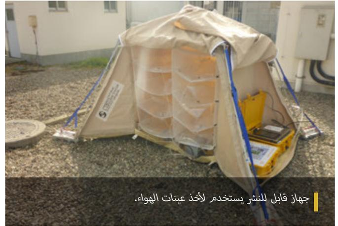
جهاز قابل للنشر يستخدم لأخذ عينات الهواء.
