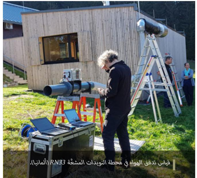
قياس تدفق الهواء في محطة النويدات المشعة RN33 (ألمانيا).
