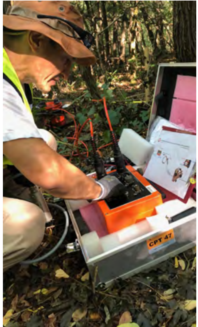
قياسات التوصيلية الكهربائية خلال الاختبار الميداني للتفتيش الموقعي لعام ٢٠١٩ المتعلقة بتقنيات التفتيش الجيوفيزيائي في هنغاريا.
