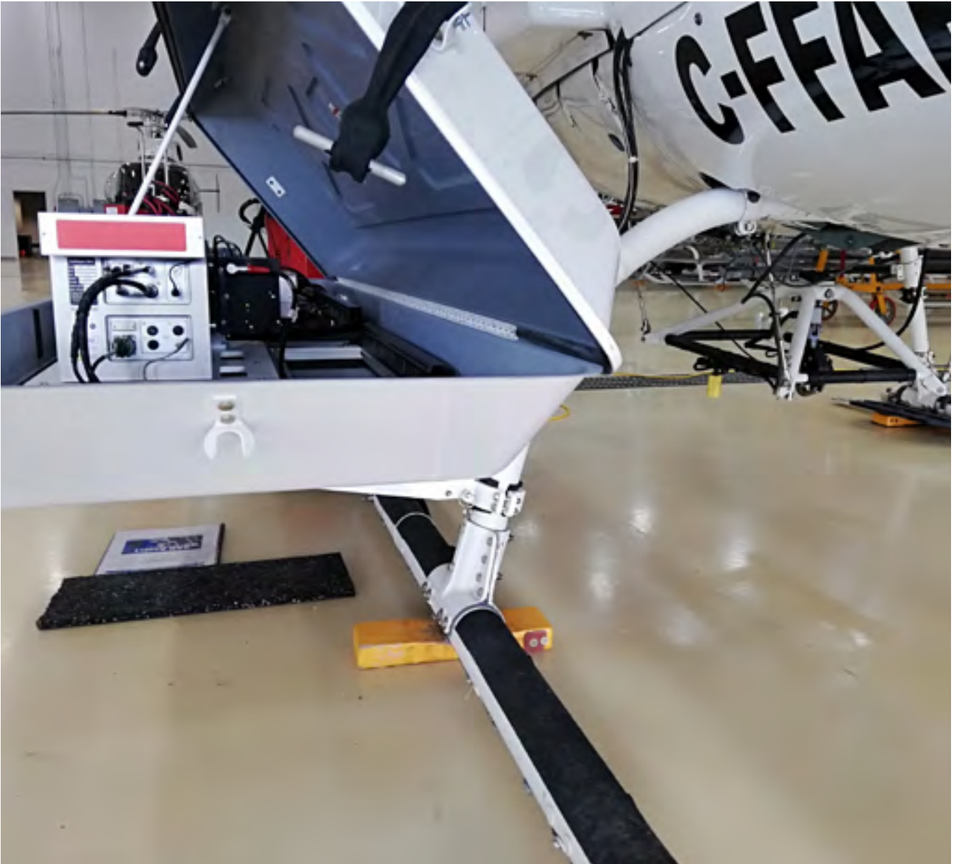
إعداد نظام "التصوير المتعدد الأطياف بما فيه التصوير بالأشعة تحت الحمراء" على متن طائرة هليكوبتر AS350 خلال دورة التدريب المتقدمة على تقنيات التفتيش الموقعي المحمولة جواً في كندا في إطار جولة التدريب الثالثة للتفتيش الموقعي لعام ٢٠١٩.
