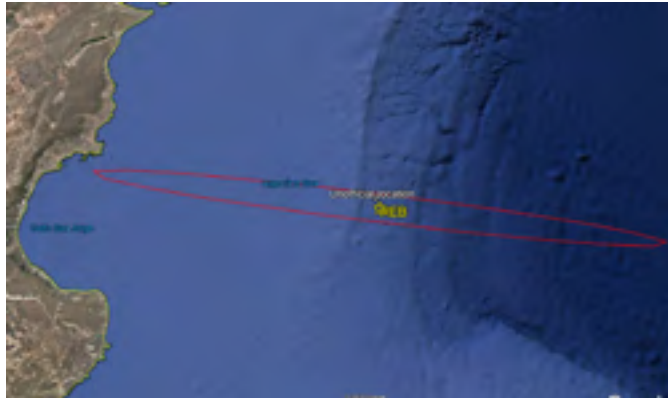
الموقع المقدر للإشارة غير العادية التي سجلتها محطات الرصد الصوتي المائي HA10 و HA4 في ١٥ تشرين الثاني/نوفمبر ٢٠١٧ (النقطة الحمراء) وإهليلج الخط المرتبط به (إهليلج الأحمر). وإهليلج الخط الأبيض ناتج عن إضافة البيانات السيزمية غير التابعة لنظام الرصد الدولي إلى الموقع التقديري استناداً إلى البيانات الصوتية المائية التابعة لنظام الرصد الدولي. وتشير النقطة الصفراء إلى الموقع المبلغ عنه للغواصة ARA San Juan والمعلن عنه في ١٦ تشرين الثاني/نوفمبر ٢٠١٨.
