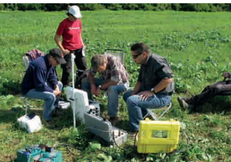
Equipo de sondeo electromagnético a gran profundidad, en funcionamiento durante una prueba de terreno realizada en Pecs (Hungría), en septiembre de 2010. Este equipo puede utilizarse en el período de continuación de una inspección in situ para detectar anomalías debidas a estructuras artificiales y equivalentes geológicos de las señales típicas de explosiones nucleares subterráneas.
