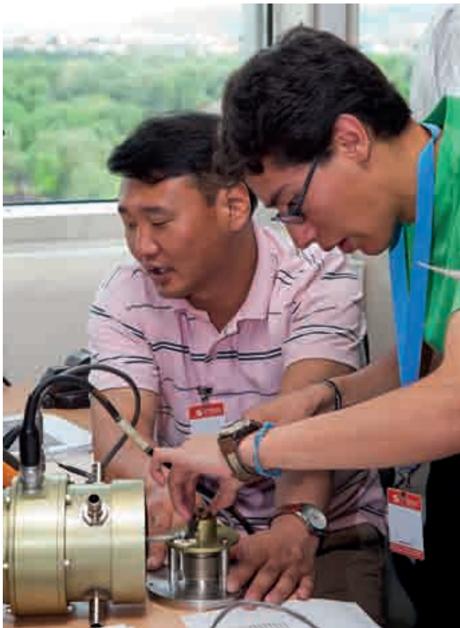
Participantes en un Curso de formación técnica para operadores de estaciones ofrecido en Viena, en 2010. A la izquierda: calibración de un barómetro de tecnología infrasonica. A la derecha: sustitución de los rodamientos y del muestreador de aire en una unidad de vigilancia de radionúclidos.
