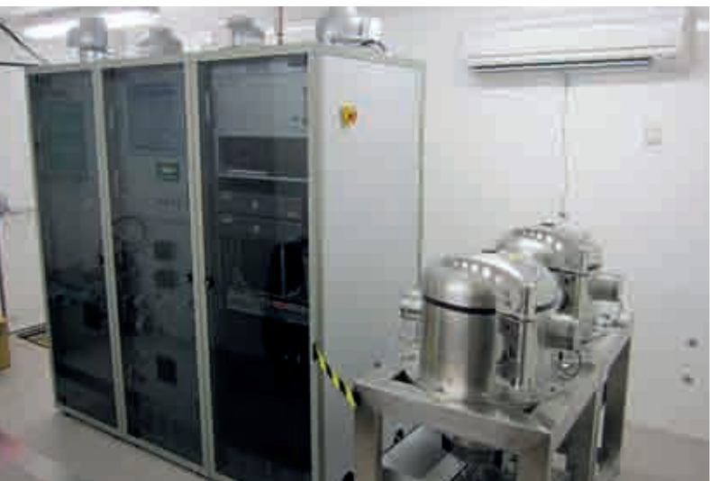
El sistema de medición de gases nobles SAUNA, instalado en la estación de radionúclidos RN68, Tristán da Cunha (Reino Unido).
