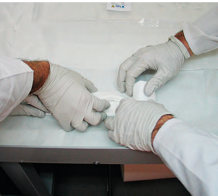
Радионуклидная лаборатория RL9, Ядерный исследовательский центр "Сорек", Явне, Израиль, которая была сертифицирована в 2012 году. Слева: Операция по закрутке полученной с помощью системы мониторинга благородных газов RASA пробы МСМ для придания ей формы цилиндрического диска путем компрессии перед проведением спектрального анализа и измерения. Справа: Интерьер лаборатории с системой детектирования (на заднем плане) и полкой для размещения электронных детекторов и компьютера.
