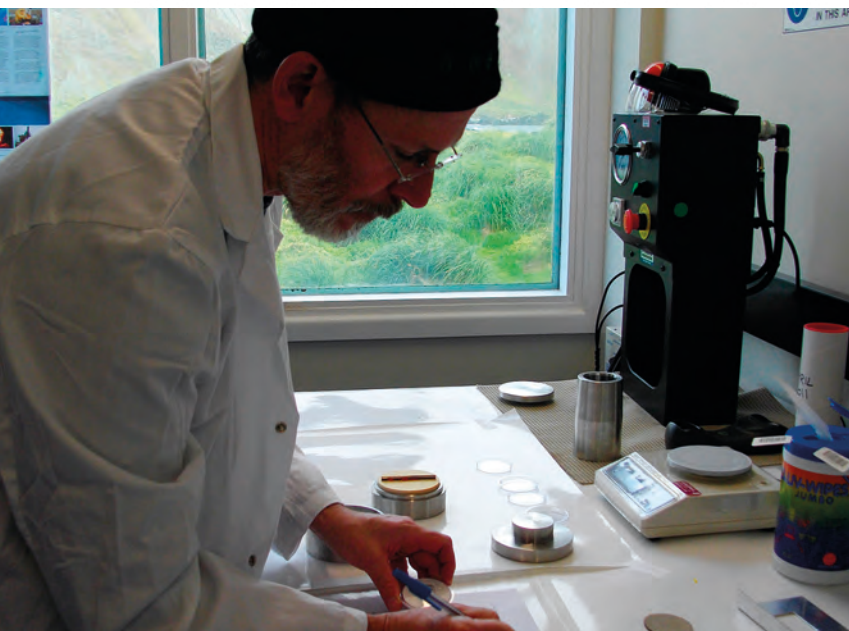
Радионуклидная станция RN7 на острове Маккуари, Австралия, которая была сертифицирована в 2012 году. Слева: Работа по подготовке фильтра после его извлечения из воздухозаборника (справа).
