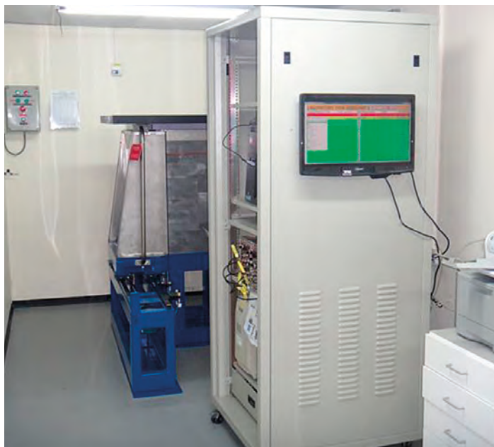
Радионуклидная лаборатория RL9, Ядерный исследовательский центр "Сорек", Явне, Израиль, которая была сертифицирована в 2012 году. Слева: Операция по закрутке полученной с помощью системы мониторинга благородных газов RASA пробы МСМ для придания ей формы цилиндрического диска путем компрессии перед проведением спектрального анализа и измерения. Справа: Интерьер лаборатории с системой детектирования (на заднем плане) и полкой для размещения электронных детекторов и компьютера.
