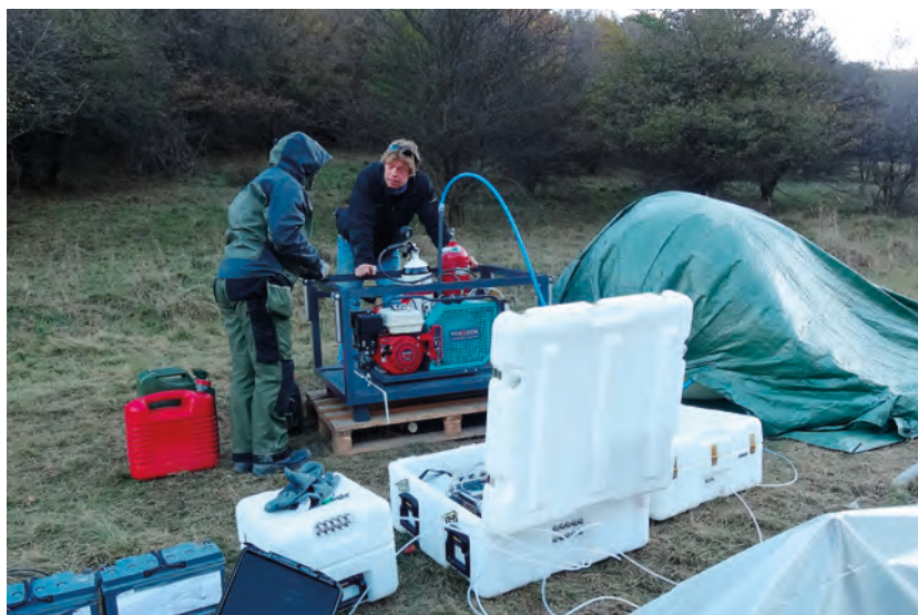
Тестирование "умного" пробоотборника, разработанного в США специально для целей проведения ИНМ (в качестве взноса натурой), в ходе полевого испытания методов отбора почвенных проб благородных газов в Словакии, октябрь 2012 года.
