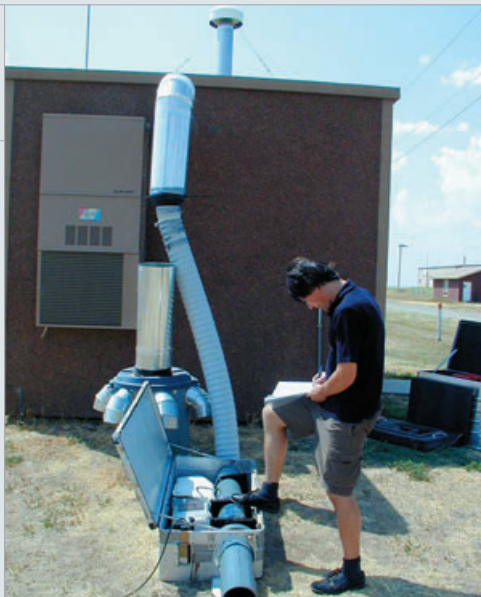
Medición de la corriente de aire en la estación de radionúclidos RN74 en Ashland, Kansas (EE.UU.).
