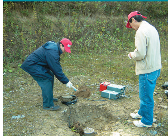
Ejercicio dirigido 2004, Eslovaquia: emplazamiento de una estación de vigilancia sismológica.
