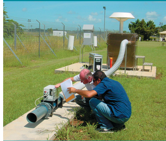
Verificación de la medición del caudal de aire del muestreador manual de macropartículas aéreas en la estación de radionúclidos RN28, Point-à-Pitre, Guadalupe, Francia.
