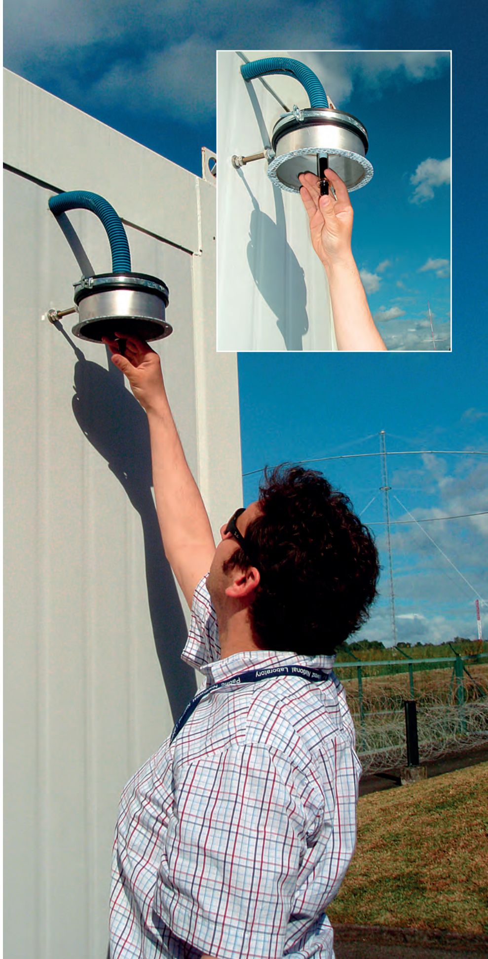
Un funcionario de la STP efectúa un ensayo de inyección durante una visita de homologación a la estación RN29, Isla de la Reunión (Francia), en el que se inyectó radioxenón en el sistema de vigilancia para evaluar su funcionamiento.
