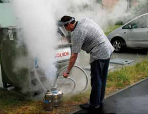
Вверху: Заправка сосуда Дьюара жидким аргоном для охлаждения системы ARIX-3F.
