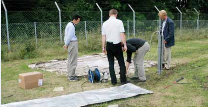
Отбор проб почвенных газов на ксенон во время испытания оборудования для анализа благородных газов в Зайберсдорфе, Австрия. Почву вокруг пробоотборного отверстия покрывают пластиковой пленкой, чтобы не допустить попадание в нее химических элементов из атмосферы. На переднем плане виден пробоотборный мешок объемом в 1 куб. метр.
