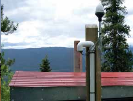
Антенна для системы глобального позиционирования на своде вспомогательной сейсмической станции AS13, Дис-Лейк, Британская Колумбия, Канада.
