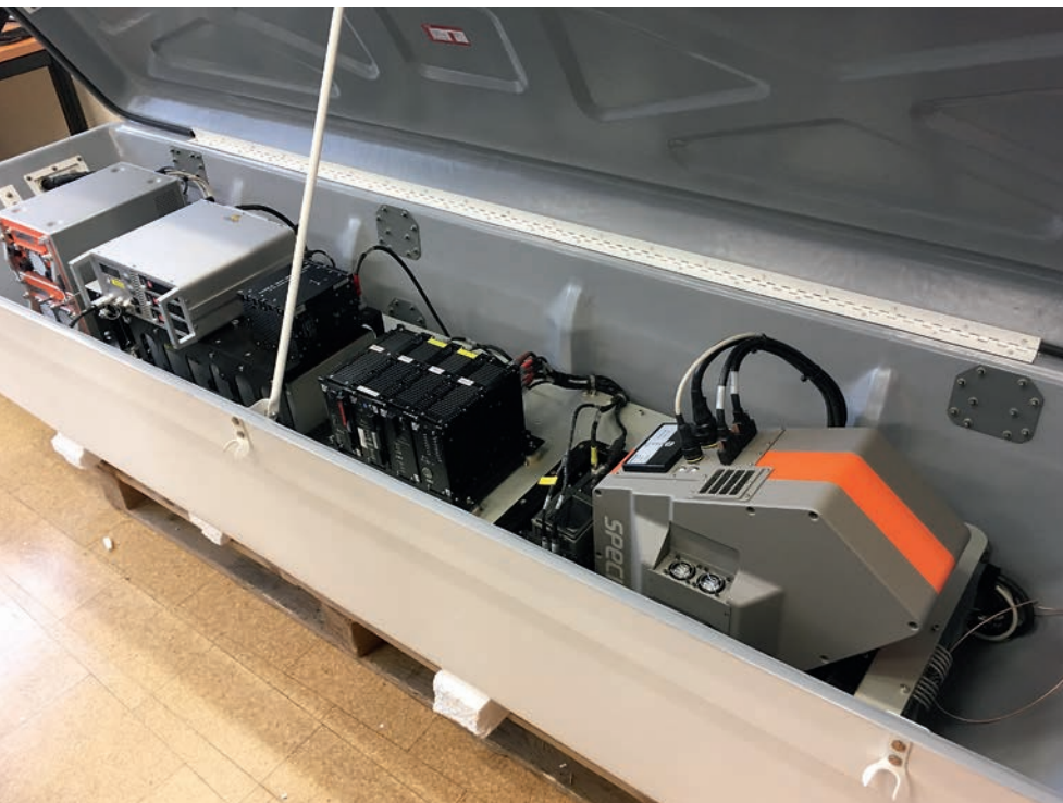
上：用于包括红外线在内的机载多光谱系统的定制座架。左：用于包括红外线在内的机载多光谱系统的组件。
