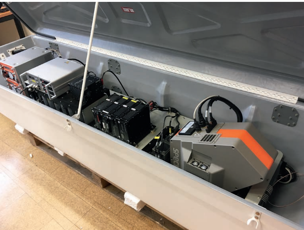
En haut : Montant construit sur mesure pour le système aéroporté d'imagerie multispectrale, y compris infrarouge. À gauche : Éléments du système aéroporté d'imagerie multispectrale, y compris infrarouge.
