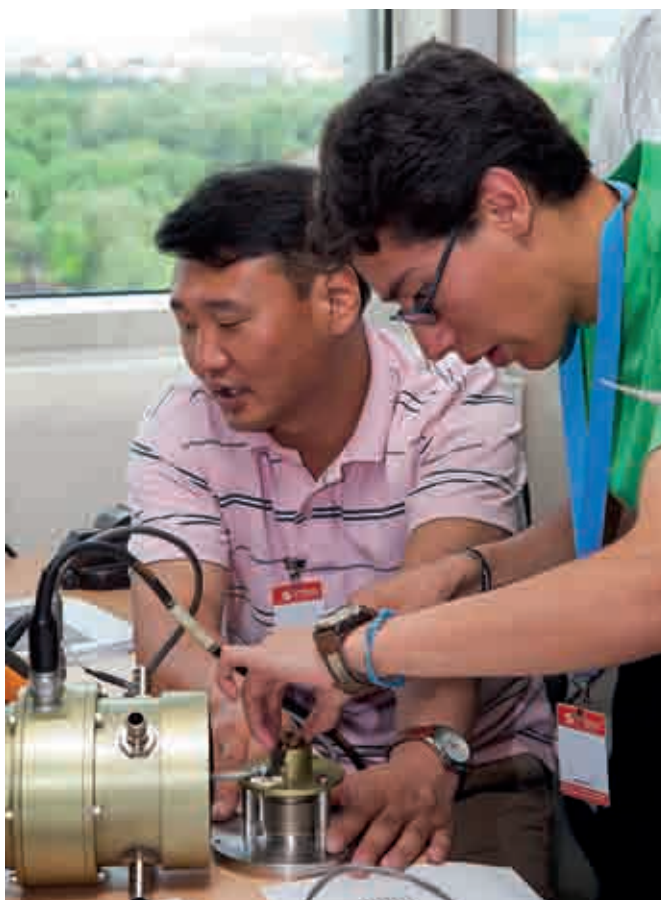
Участники технического курса подготовки операторов станций, проведенного в Вене в 2010 году. Слева: калибровка инфразвукового барометра. Справа: замена подшипников и устройства для отбора проб воздуха в установке радионуклидного мониторинга.
