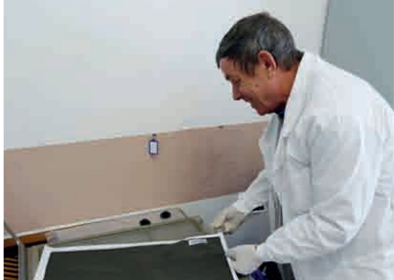
Радионуклидная станция RN58: фильтр, извлеченный из прибора для снятия проб воздуха, до прессовки.
