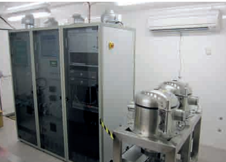
Система мониторинга благородных газов модели SAUNA на радионуклидной станции RN68, остров Тристан-да-Кунья (Соединенное Королевство).
