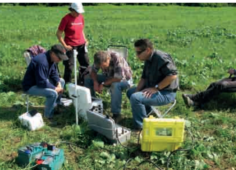
Оборудование для глубокого электромагнитного зондирования работает во время полевых испытаний в Пече, Венгрия, сентябрь 2010 года. Такое оборудование можно использовать в продолжение инспекции после ИНМ для выявления аномалий, вызванных искусственными структурами, и геологических эквивалентов сигналов, типичных для подземных ядерных взрывов.
