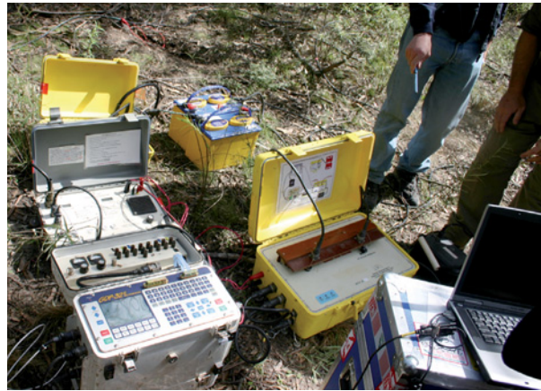
Демонстрация оборудования для ИНМ, Австралия: оборудование для измерения сопротивления.
