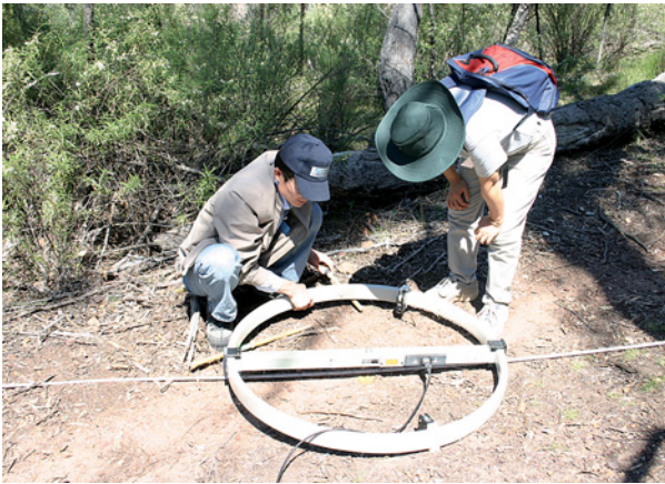
Демонстрация оборудования для ИНМ, Австралия: нивелировка приемной рамки, используемой для контроля наведенных магнитных полей.
