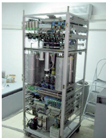
Две новые системы мониторинга благородных газов, установленные в 2005 году в Стокгольме (SAUNA-II) и Буэнос-Айрес (ARIX-02).
