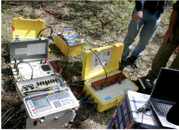
عرض إضاحي لمعدات التفتيش الموقعي، أستراليا: معدات لقياس قابلية الصمود.
