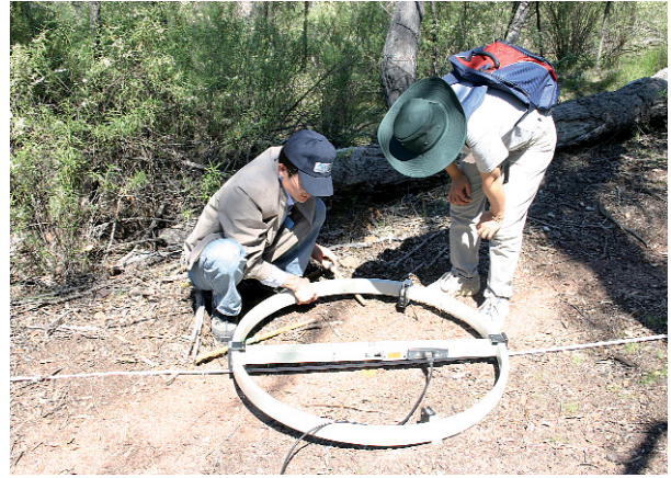
عرض إضاحي لمعدات التفتيش الموقعي، أستراليا: بسط وشبعة جهاز استقبال يستخدم في قياس الحقول المغناطيسية المستحثة.
