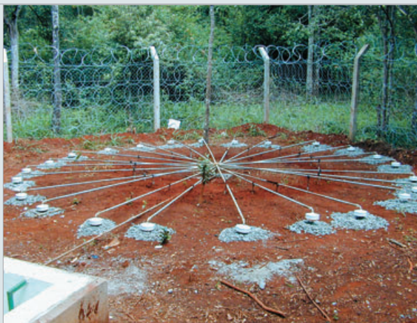
减少风声噪音的排管阵，肯尼亚内罗毕次声台站 IS32。
